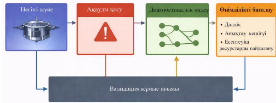
Сурет 5 – Борттық ЖИ негізіндегі диагностикалық жүйе үшін модельдеу ортасы және валидация жұмыс процесі
